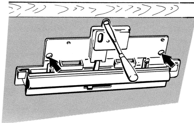
Zunge in Weiche einrasten. Bei Platten von 8–12 mm Zunge mit Rundloch, bei 12–25 mm Zunge mit Langloch. Überstehenden Steldraht kürzen.
