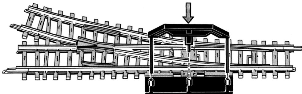
Bodenplatte aufstecken. 3 Bohrlöcher anzeichnen, evtl. etwas vorbohren.
