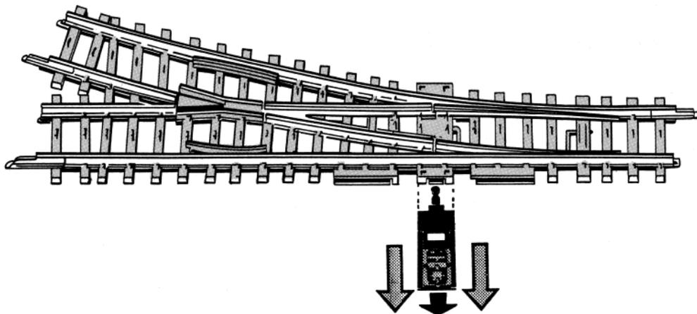
Schablone anlegen, 3 Löcher 2,2 mm Ø durch die Grundplatte bohren.
