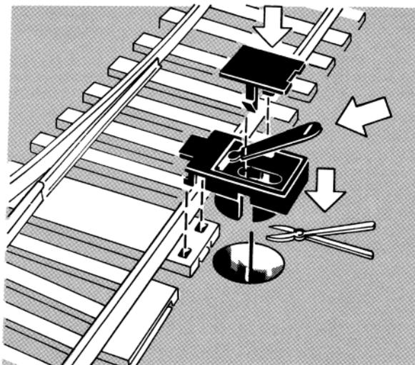
Tungan rastas in i växeln. Vid plattor med 8–12 mm tjocklek används tungor med rundhål, vid 12–15 mm tjocklek används tungor med ovalt hål. Överskjutande justertråd kortas ner.
