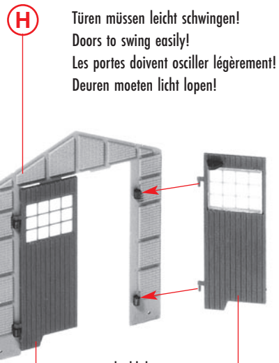
I E D nicht kleben do not glue ne pas coller niet lijmen
