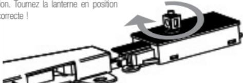
Schalthebel des Weichenantriebs in Richtung Weichensignal bringen und festhalten. Dann Weichensignal, Verbindungsstange und Antrieb zusammenschlieben. Shift the handle of the point motor towards the point signal side and hold it. Doing so, gently fit together point signal, lever and point motor. Poussez la poignée du moteur d'aiguille vers le côté de signal de point et le tient. Faire alors, doucement introduire ensemble le signal de point, le levier et le moteur d'aiguillage.
