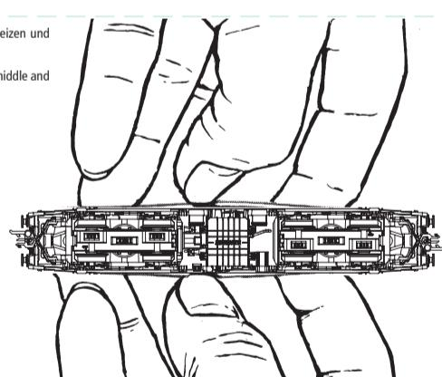
2. Halteklemmen aufbiegen. Platine und Motor ausbauen.
