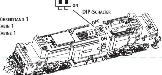
Hinweis: Die Schlussbeleuchtung der Lok kann mit Hilfe der DIP-Schalter S1 (für FS2) oder S2 (für FS1) auf der Platine für jede Lokseite abgeschaltet werden.
