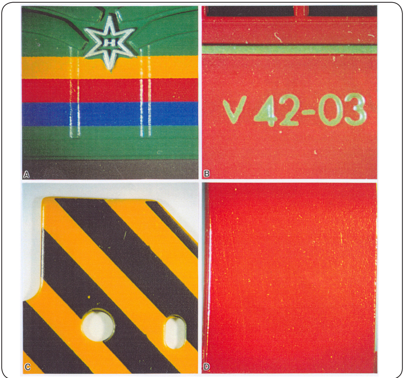
Abb. 6: Stereoskopische Aufnahmen von verschiedenen Modellbahnbestandteilen mit Farbzeichnungen nach einwöchiger Inkubation in DRÖI-Dampfreinigungsöl der Firma modellbahnprofi.com, A Rangierlokomotive der Firma Märklin in Frontansicht, B Rangierlokomotive der Firma Fleischmann in Seitenansicht, C Aufsicht auf den Blender der Rangierlokomotive der Firma Fleischmann, D Blick auf die Bodenplatte des Tenders der Roco-Dampflokomotive (Afl., Vergr. 6,5x)
